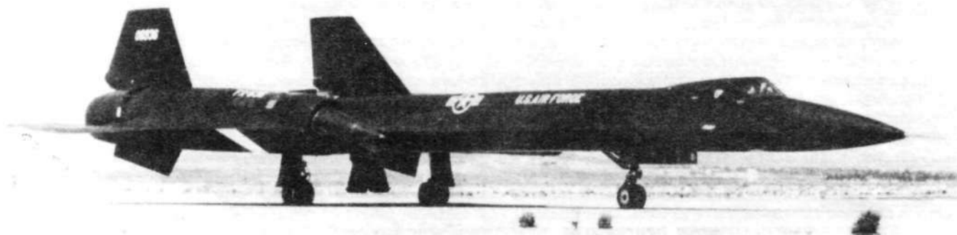
Белая полоса под мотогондолой УФ-12А - часть огромной крестообразной метки для замеров при съемках
